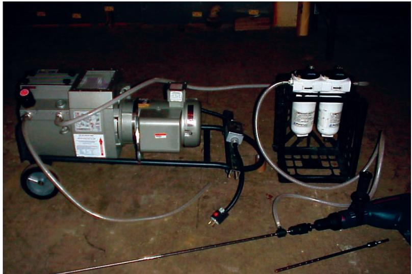
図1：コンクリート放射化学プロファイリング装置
