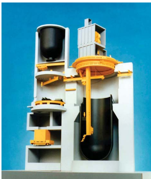
図2：遠隔解体装置のモデル
