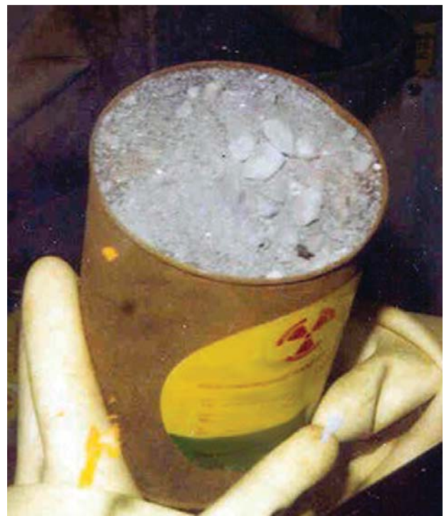
PFP のグローブボックス内に置かれた、SS&C (砂・スラグ・るつぼ) と呼ばれるプルトニウム残留物。WIPP で最終処分するための研削と再封入の直前の段階。
