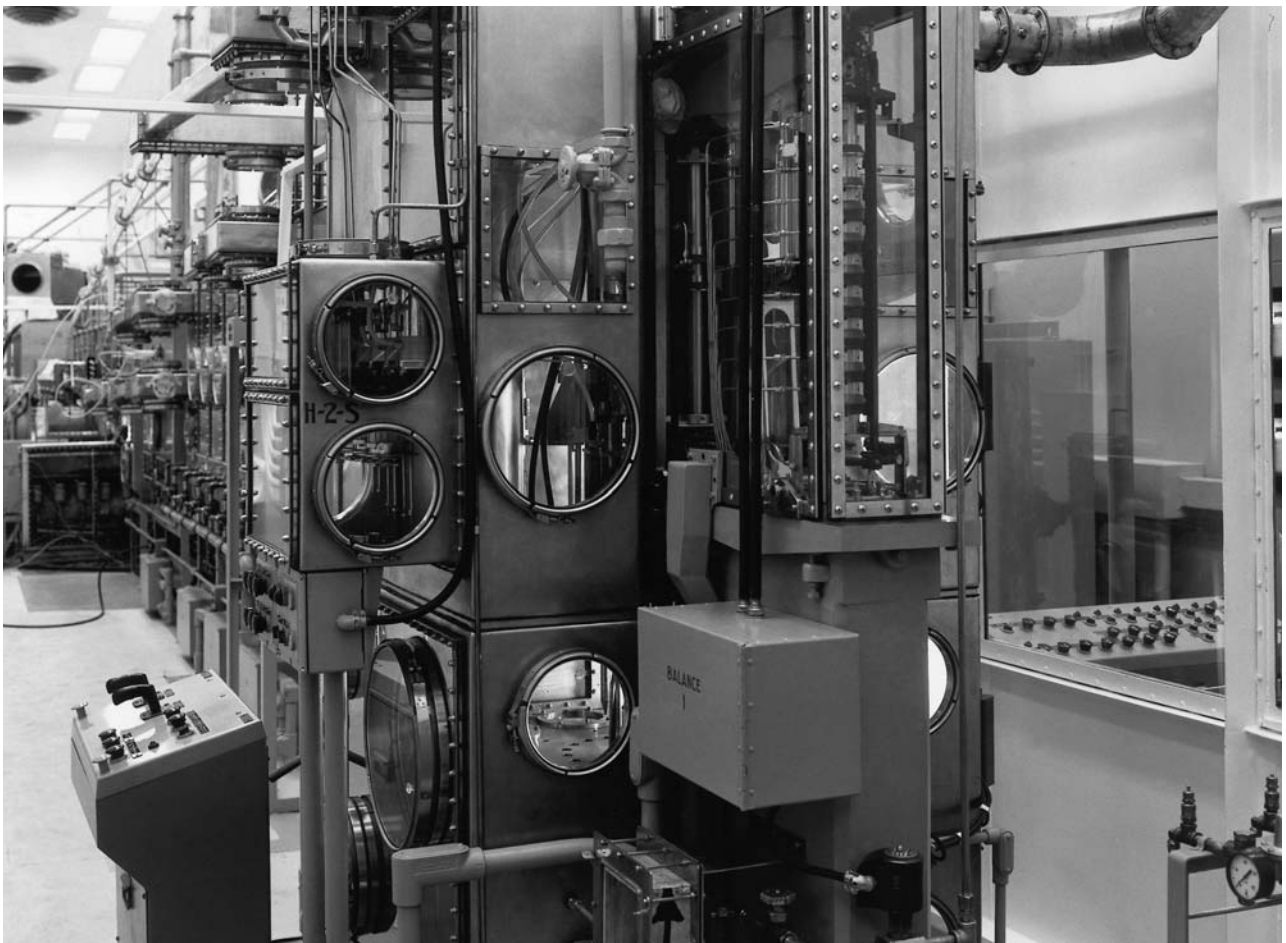
PFPのAラインの初期グローブボックス。生産規模でプルトニウム最終処理を行うための世界初の遠隔機械式グローブボックス装置。1951年にハンフォードのダッシュ5建屋に据え付けられ、現在は、PFP活動停止作業の一環として清浄、分断、除去が行われている。
