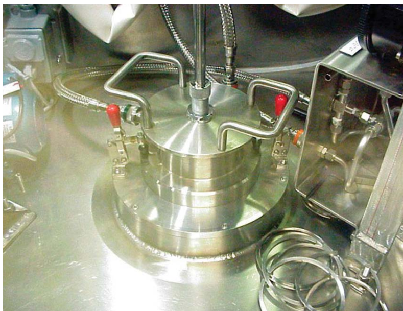
3013規格のキャニング工程では、安定化されたプルトニウムを保持する缶にヘリウムが充填される。ハンフォードの PFP は、厳格な3013規格に準じる最初の DOE 施設である。
