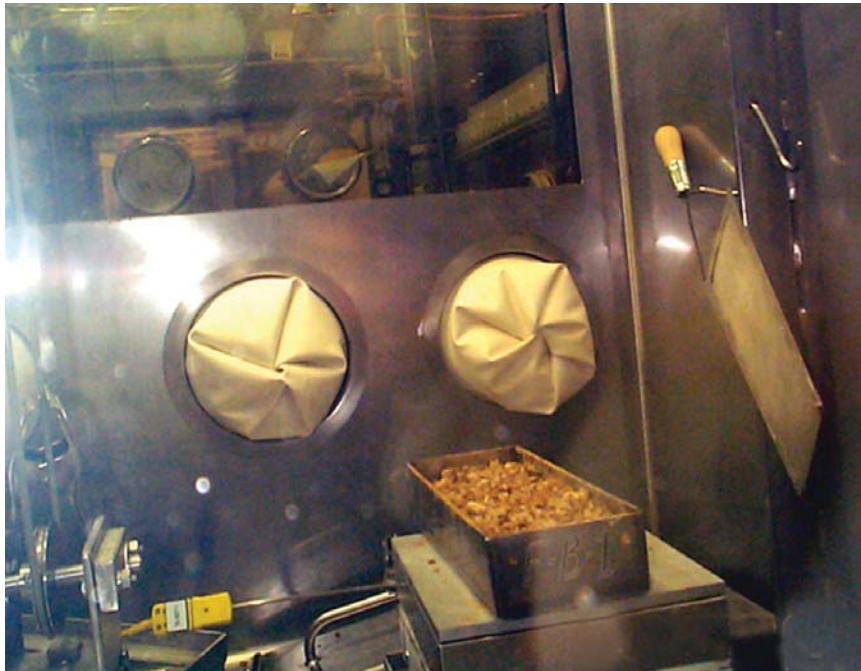
ハンフォード PFP のグローブボックス内に置かれた、プルトニウム含有溶液から得られた安定化された酸化プルトニウムを保持する、ポートと呼ばれる小型コンテナ。同施設は、2002年7月に溶液安定化作戦を完了した。
