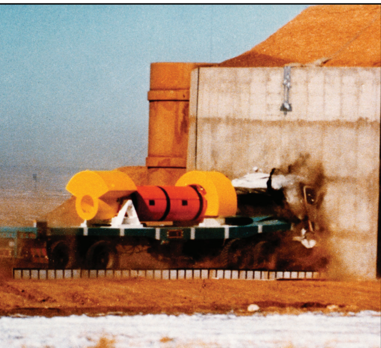
1970年代、サンディア国立研究所は、使用済み核燃料の輸送キャスクの試験を行い、高速でコンクリート壁へこのキャスクとそのトラック輸送車を激突させた。このキャスクは衝撃に耐えた。（写真提供：サンディア国立研究所）
