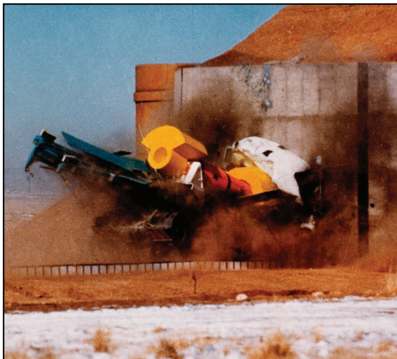
1970年代、サンディア国立研究所は、使用済み核燃料の輸送キャスクの試験を行い、高速でコンクリート壁へこのキャスクとそのトラック輸送車を激突させた。このキャスクは衝撃に耐えた。（写真提供：サンディア国立研究所）
